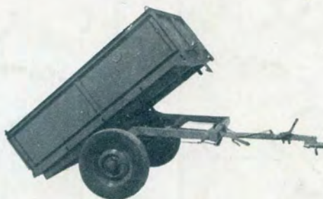
Remolque metálico, volquete, para 1.000 y 1.500 Kgs. de carga.
